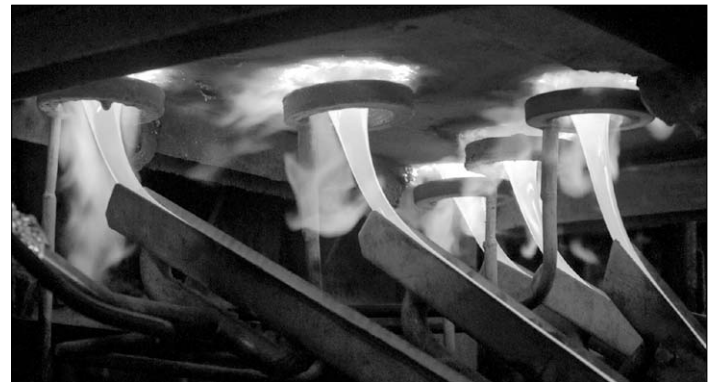
Ringbrenner mit Glasausfluss für fünf Verarbeitungsstränge zur Herstellung von Pellets
